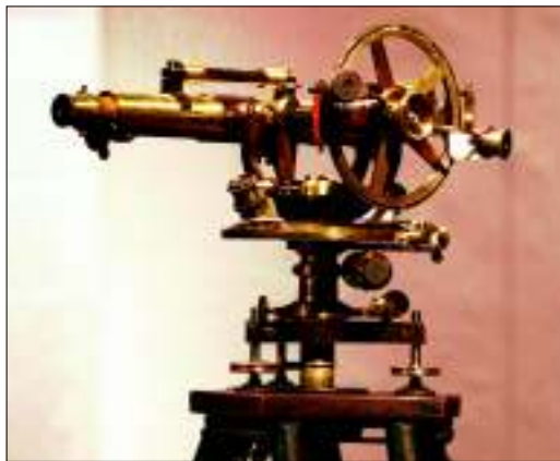
Messgerät: Mithilfe eines Universaltheodoliten stellte Boas auf Baffinland Messungen für eine Karte der von ihm bereisten Gebiete an.
